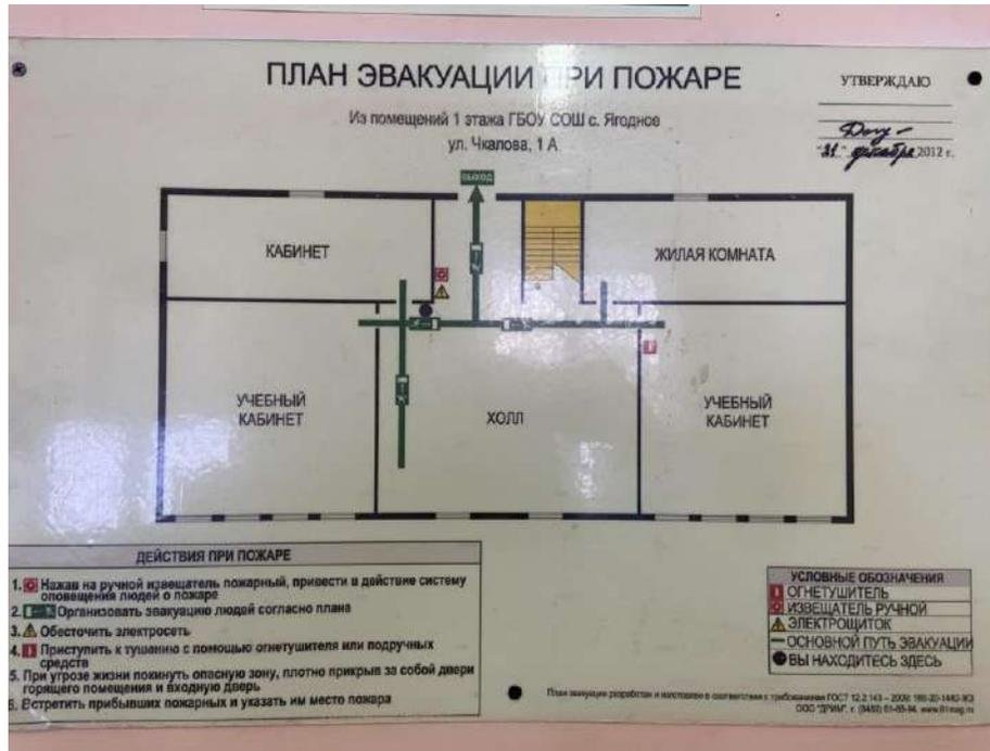
Фото №18 План эвакуации 1 этаж
